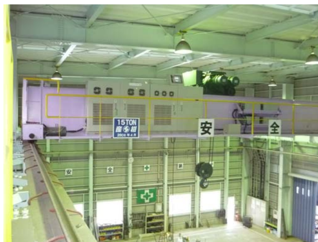
【リチウムイオン・キャパシタ搭載のハイブリッドクレーン】
